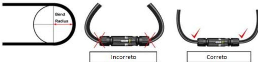
Figura 5: O roteamento correto e o raio de curvatura mínimo dos cabos.
